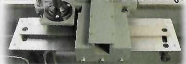
L'Attachement conique doit être commandé avec le tour à métal
